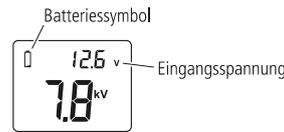
Liegt die Spannung außerhalb der normalen Bandbreite (unter 11,8 V oder über 17 V), blinkt das Batteriesymbol.
