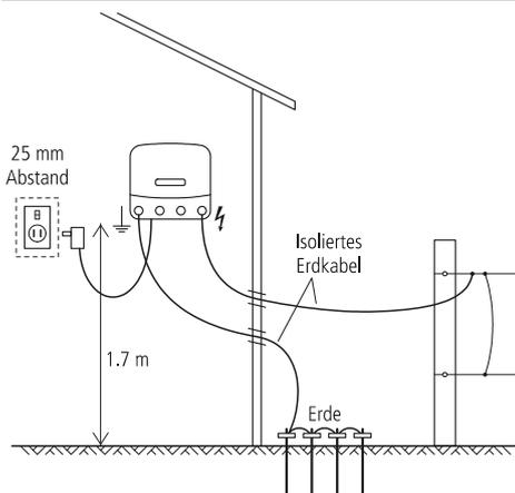
*Hinweis:* Wird ein Elektrozaungerät in einem Gebäude installiert, kann es nötigenfalls statt mit Netzstrom auch mit Batteriestrom betrieben werden.
