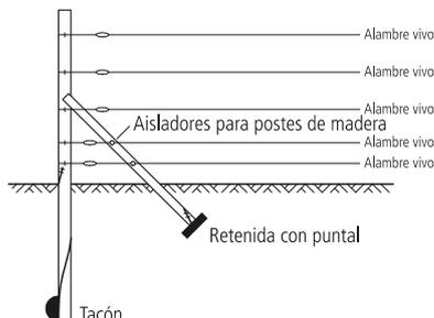
Sistema con conductor de retorno por tierra
