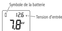
Si la tension est en dehors de l'intervalle normal (inférieure à 11,8 V ou supérieure à 17 V), le symbole de la batterie clignote.
