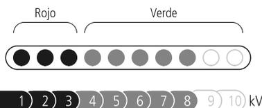
*Nota:* Si diez segmentos están iluminados, el voltaje de salida puede ser superior a los 10 kV (10.000 V).
