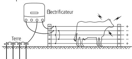
*Note* : la surveillance de la mise à la terre ne fonctionne pas pour une installation bipolaire.
