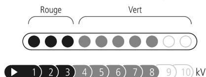
*Note* : si dix témoins sont allumés, la tension de sortie peut se situer à plus de 10 kV (10000 V).
