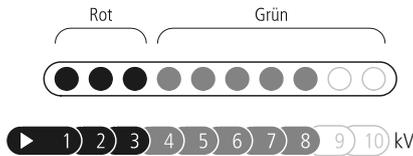
**Hinweis:** Wenn zehn Anzeigelämpchen aufleuchten, beträgt die Ausgangsspannung möglicherweise mehr als 10 kV (10.000 V).
