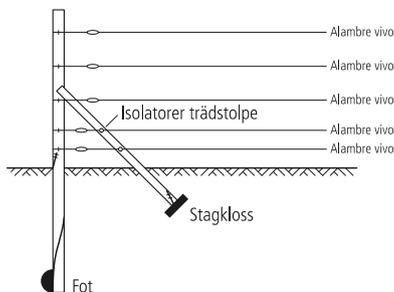
System med stängselåterledning
