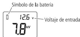
Cuando el voltaje está fuera del rango normal (inferior a 11,8 V o superior a 17,0 V), el símbolo de la batería parpadea.
