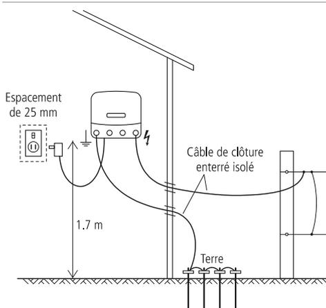
*Note* : si l'électrificateur est installé à l'intérieur, il peut, si nécessaire, être alimenté sur batterie au lieu de l'alimentation sur secteur.
