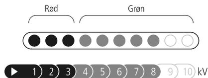
*Henvisning:* Hvis der er ti segmenter, der lyser, kan udgangsspændingen være over 10 kV (10.000 V).
