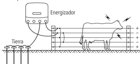
**Nota:** En una instalación bipolar no es posible utilizar la función 'monitoreo de toma a tierra'.
