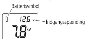
Hvis spændingen ligger uden for det normale område (under 11,8 V eller over 17 V), blinker batterisymbolet.
